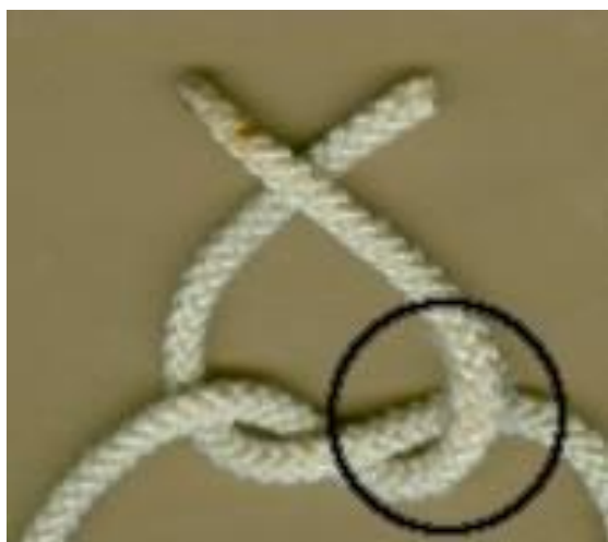
Volný konec vycházející nad pevným koncem překřížíme přes konec vycházející pod druhým pevným koncem.
